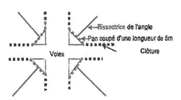
Pour l'édification des clôtures à l'angle de deux voies, ou bien, le long des routes à lacets, il devra être aménagé pour la visibilité, un pan coupé de 5 mètres de longueur tracé perpendiculairement à la bissectrice de l'angle ou une courbe inscrite dans le gabarit. Le plan ci- contre explique le dispositif.
